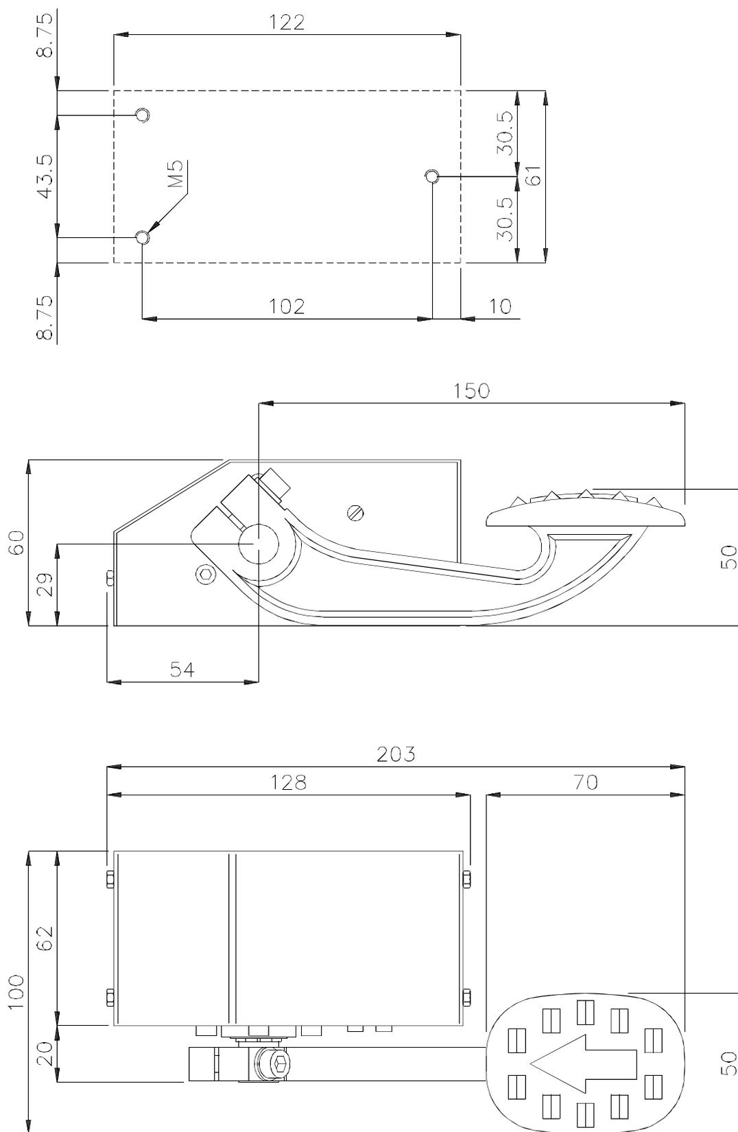
Per la versione destra considerare l'ingombro del pedale dalla parte opposta del corpo scatola. N.B. tutte le dimensioni sono in millimetri
